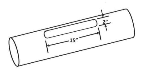
BEFORE CUTTING, REMOVE END BEARING/ OVERFLOW ENDCAP AND PLASTIC FLIGHTING.
