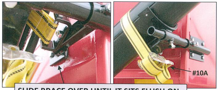
SLIDE BRACE OVER UNTIL IT SITS FLUSH ON THE GRAVITY BOX WALL. DRILL AND BOLT TO WALL
