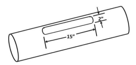
BEFORE CUTTING, REMOVE END BEARING/ OVERFLOW ENDCAP AND PLASTIC FLIGHTING.
